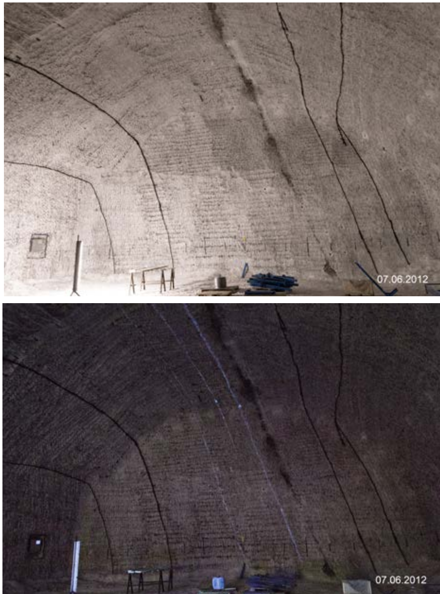
Abb. 57: Westerweiterung des Bohrortes 5.0 bei Kunstlicht (obere Aufnahme) und unter UV-Strahlung (untere Aufnahme). Die drei KW-Bänder sowie das im Hangenden der KW-Bänder befindliche, boudinierte Anhydritband folgen der Streichrichtung der Salzgesteine von SW-NE (Aufnahmen: DBE).
