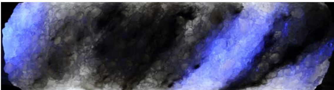
Abb. 10: Kombinationsaufnahme „Durchlicht und UV-Strahlung“ für einen Probenkörper aus dem Streifensalz (RB773-001 bei Teufe 0,70 m bis 0,94 m). Die lagenartig ausgebildeten, UV-aktiven Bereiche befinden sich innerhalb des betrachteten Kernsegmentes ausschließlich an den Korngrenzen klarer, rekristallisierter Halitkristalle.
