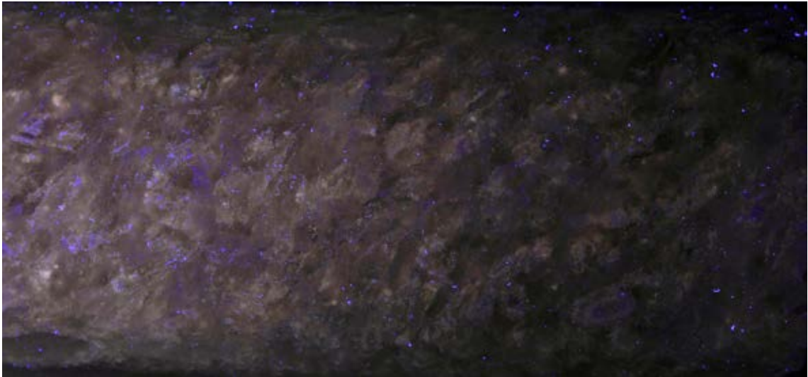
Abb. 2: Kernsegment aus der Bohrung RB669 (Teufe 8,30 m bis 8,44 m) mit gelblich-oranger Eigenfluoreszenz. An den Korngrenzen der Halitkristalle sind zahlreiche kleine gelblich-orange Fluoreszenzcentren zu erkennen. Die Aufnahme wurde unter Verwendung des Programms Photoshop aufgehellt und der Kontrast reduziert, um die auf dem Originalphoto schwer zu erfassende Eigenfluoreszenz zu verstärken.
