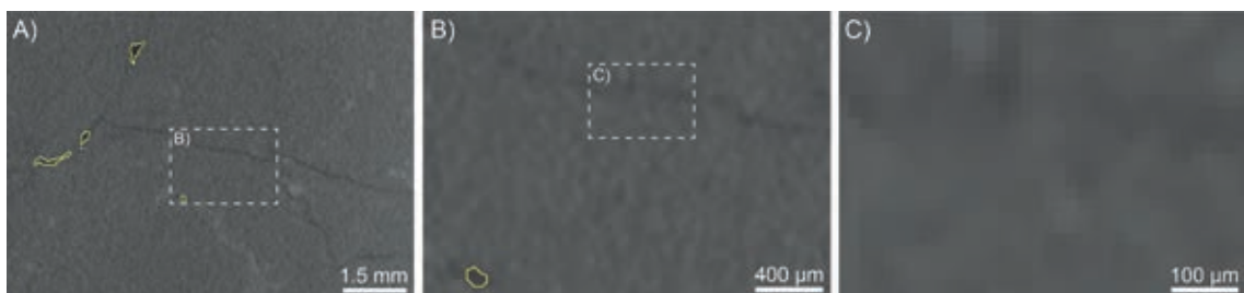
Abb. 36: Problematik der Extraktion diffuser Fluidvorkommen oder Porenräume mit VGStudio . A: Intakte Korngrenzen sind für das menschliche Auge noch zu erkennen, verschwimmen jedoch bei starker Vergrößerung im Datensatz (B und C). Eine Extraktion dieser Speicherräume oder potenzieller Migrationswege ist beim ImageJ -Verfahren automatisiert und manuell nicht durchführbar (Photos: N. Thiemeyer).
