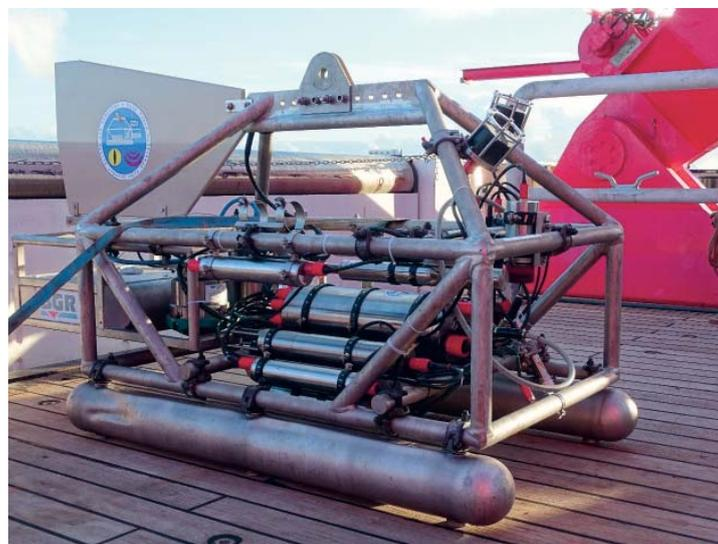
**Abb. 3:** Die HOMESIDE-Vermessungsplattform vor einem Einsatz 2017 auf TFS Sonne. An der Vorderseite sind diverse wasserchemische Sensoren und ein Kollisionsvermeidungs-Sonar integriert.
